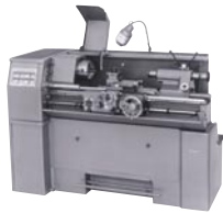
Lançamento do torno Romi modelo HBX, único com variação contínua de velocidades
