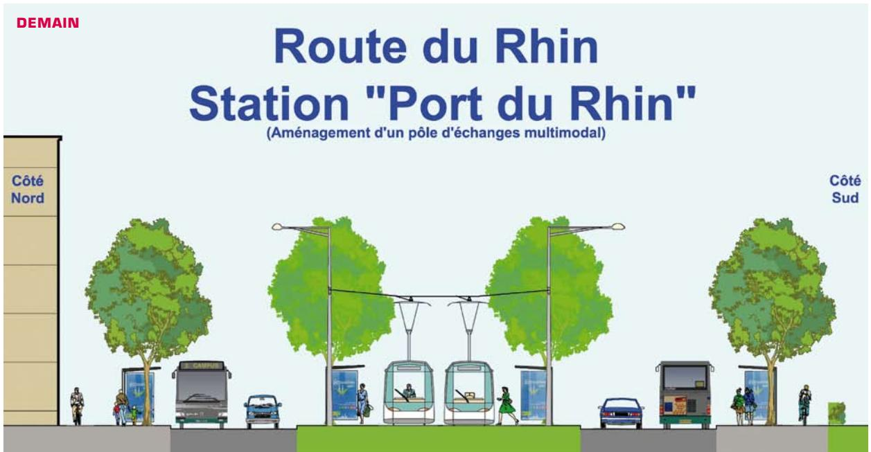
Le tram circule en site central. Les automobiles ainsi que les bus circulent sur une file par sens de part et d'autre de la plate-forme tram. Les cyclistes et les piétons bénéficient d'aménagements sécurisés de chaque côté de la chaussée.
