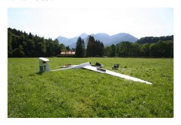
Der Aufprall erfolgte mit dem Rumpfbug und der linken Tragflächenspitze. Dabei wurde das Cockpit zertrümmert und der Tragflächenverbund zerbrach. Das Fahrwerk wurde ausgefahren, aber nicht verriegelt vorgefunden. Die Untersuchung am Luftfahrzeug ergab keine Hinweise auf eine technische Störung.
