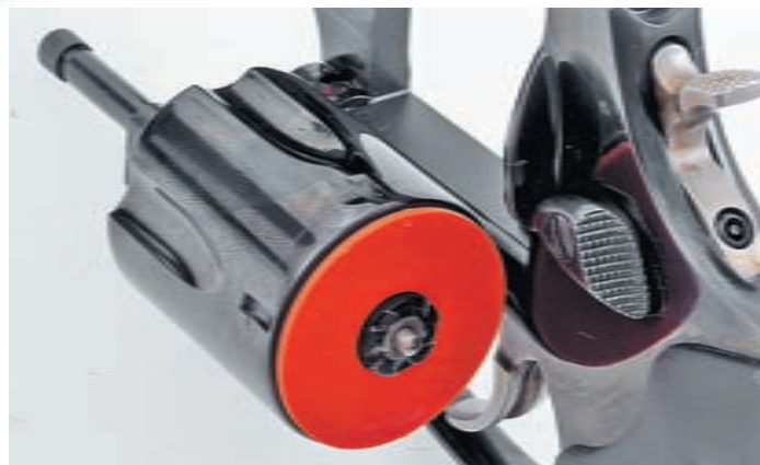
Вместо обоймы можно вставить яркий полимерный диск, который при визуальном осмотре указывает на то, что оружие разряжено
