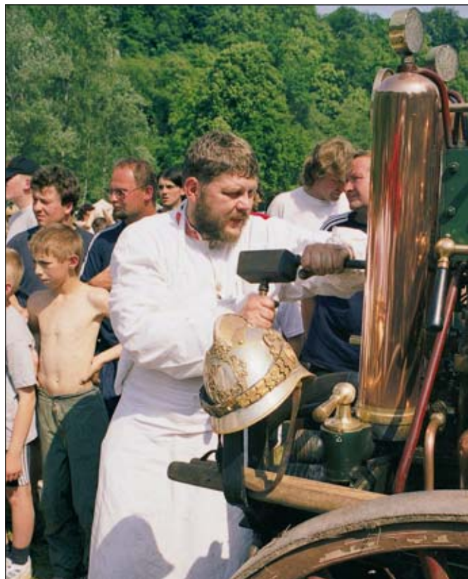
POSLEDNÍ. Jaroslav Grosman z Roztok u Jilemnice seřizuje parní stříkačku z roku 1907, která z Dolních Louček v okrese Brno-venkov dotlačila vodu až na nejvyšší bod Žďárských vrchů – vrchol Devět skal ve výšce 836 m n.m.
