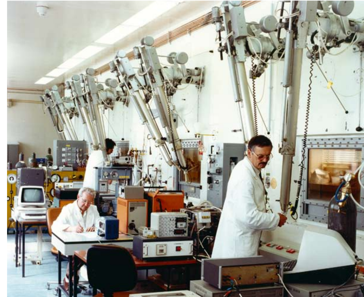
Heißzellenanlage von der Bedienungsseite
