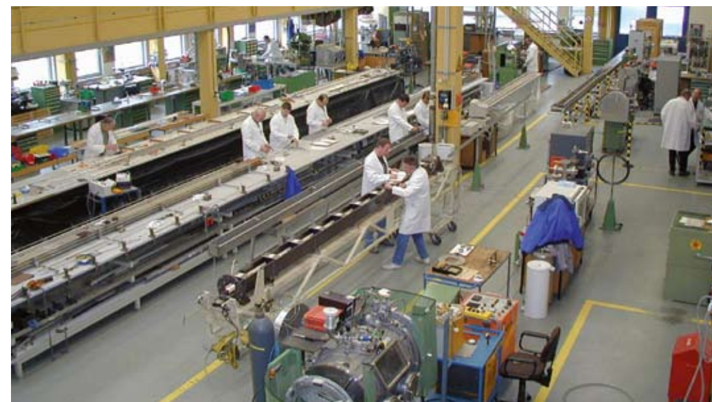
Fertigung von Inkern-Instrumentierung
