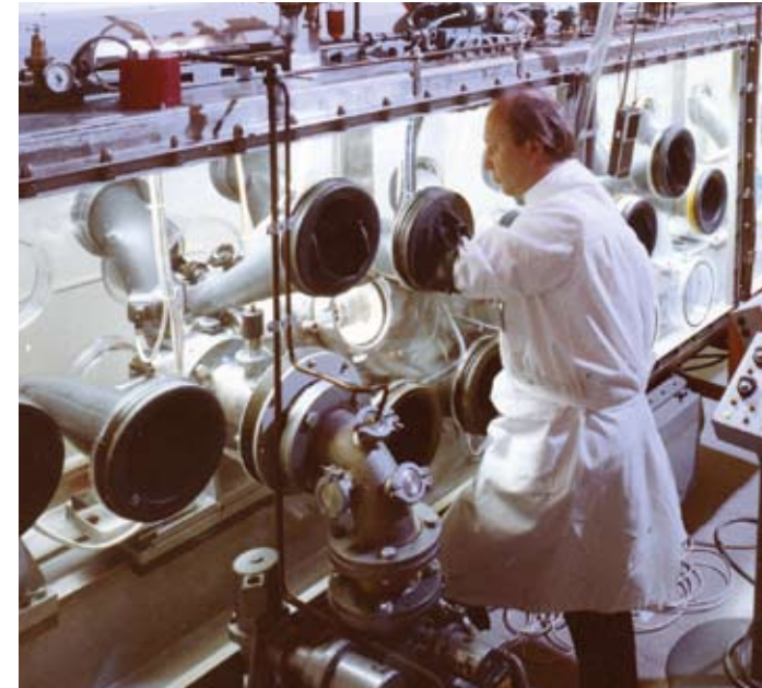
Handschuhkästen für den Umgang mit Plutonium
