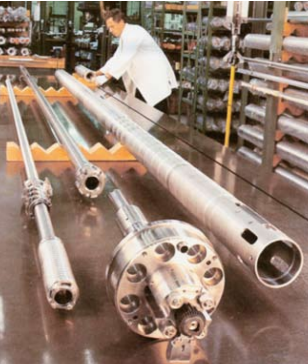
Montage von Steuerstabtrieben für Kernkraftwerk Gundremmingen B
