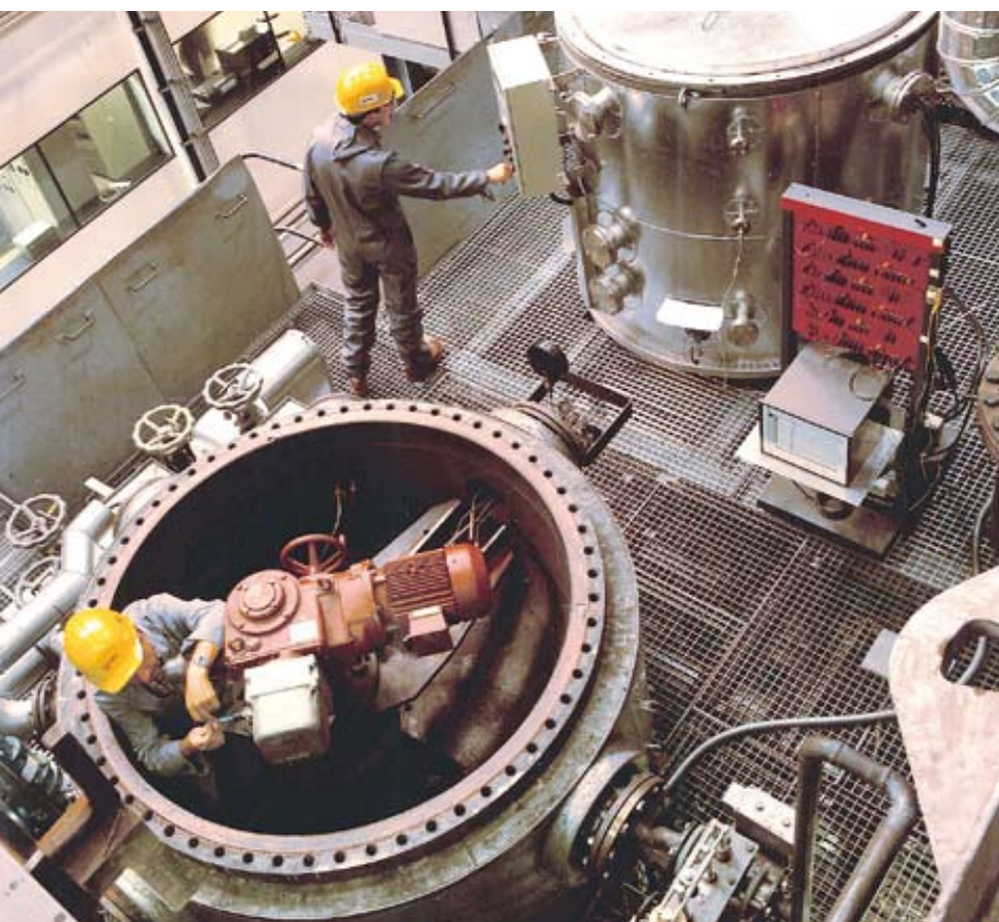
Typprüfung eines motorbetriebenen Ventilantriebs
