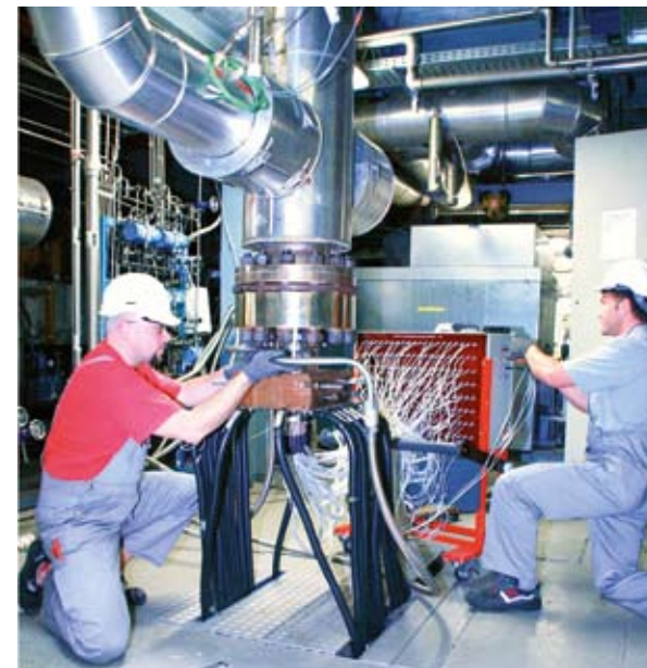
Thermohydraulischer Versuchstand KATHY für Brennelementtests
