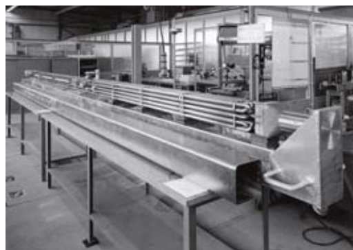
Ein Brennelement des Heißdampfreaktors
