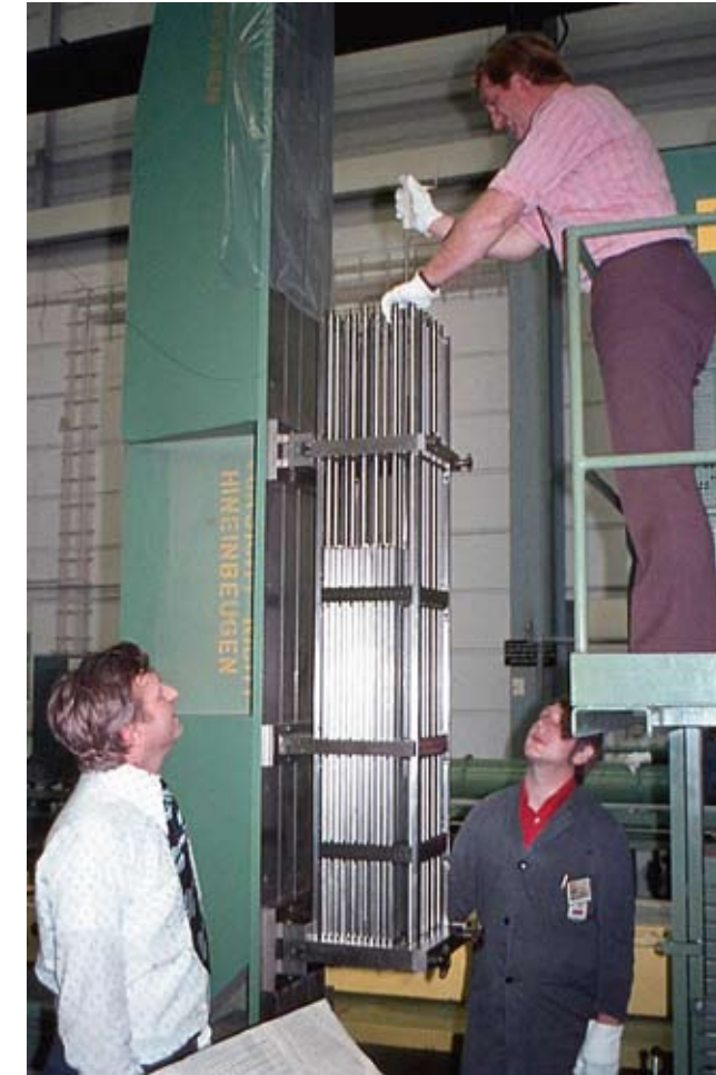
Brennelement für das Nuklearschiff „Otto Hahn“
