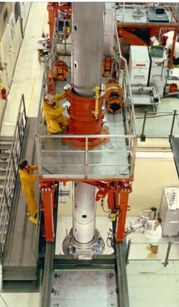
Zentralmastmanipulator in der Erprobung (1989)
