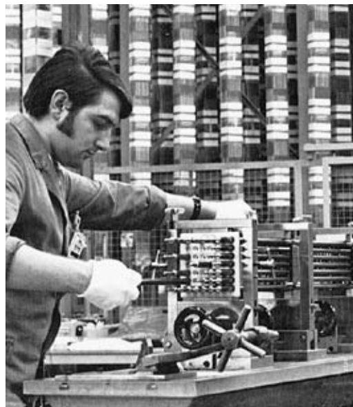
Assemblierung eines SWR-Brennelements
