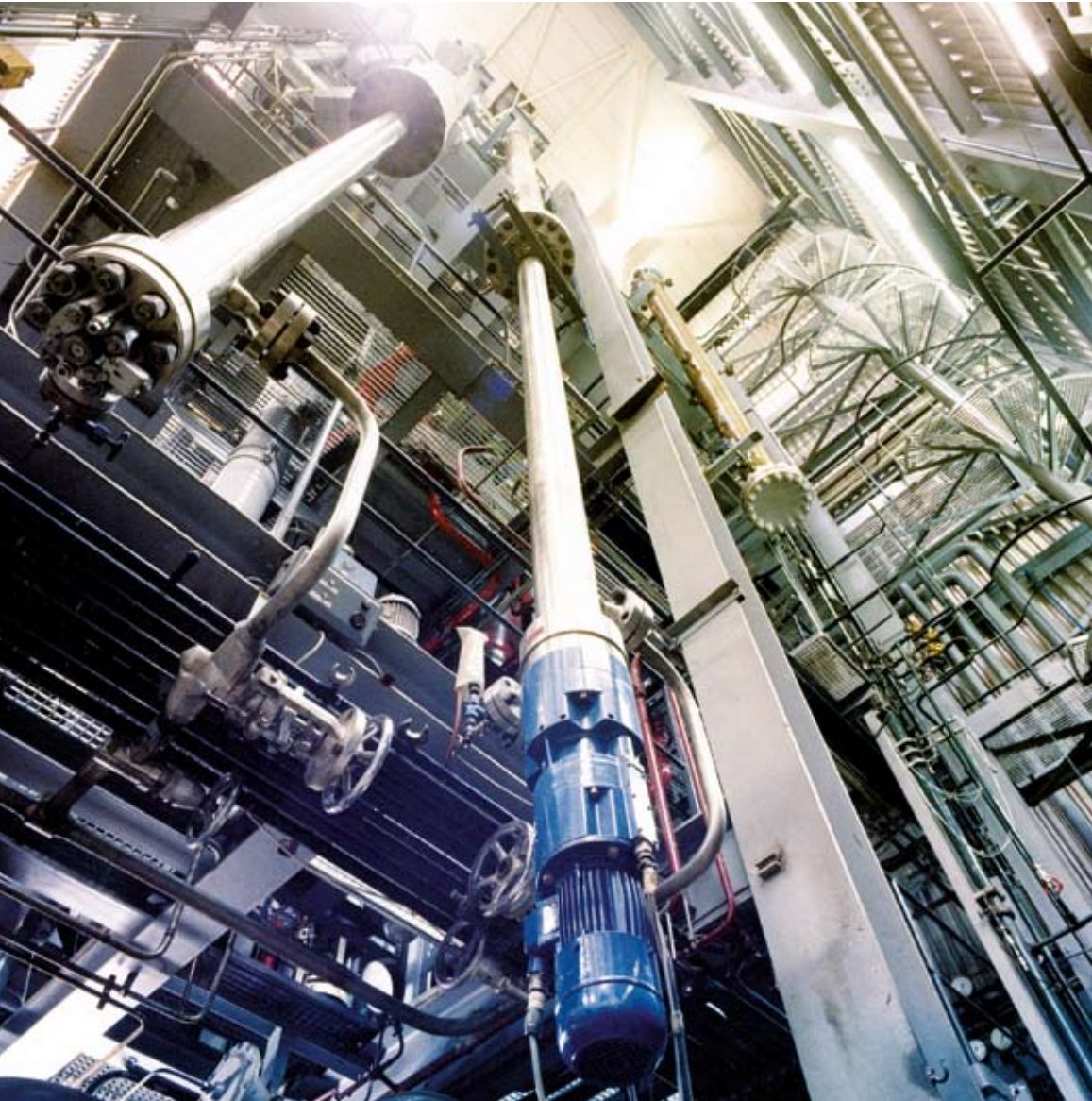
Teststand für Steuerstabantriebe in der Technikumshalle
