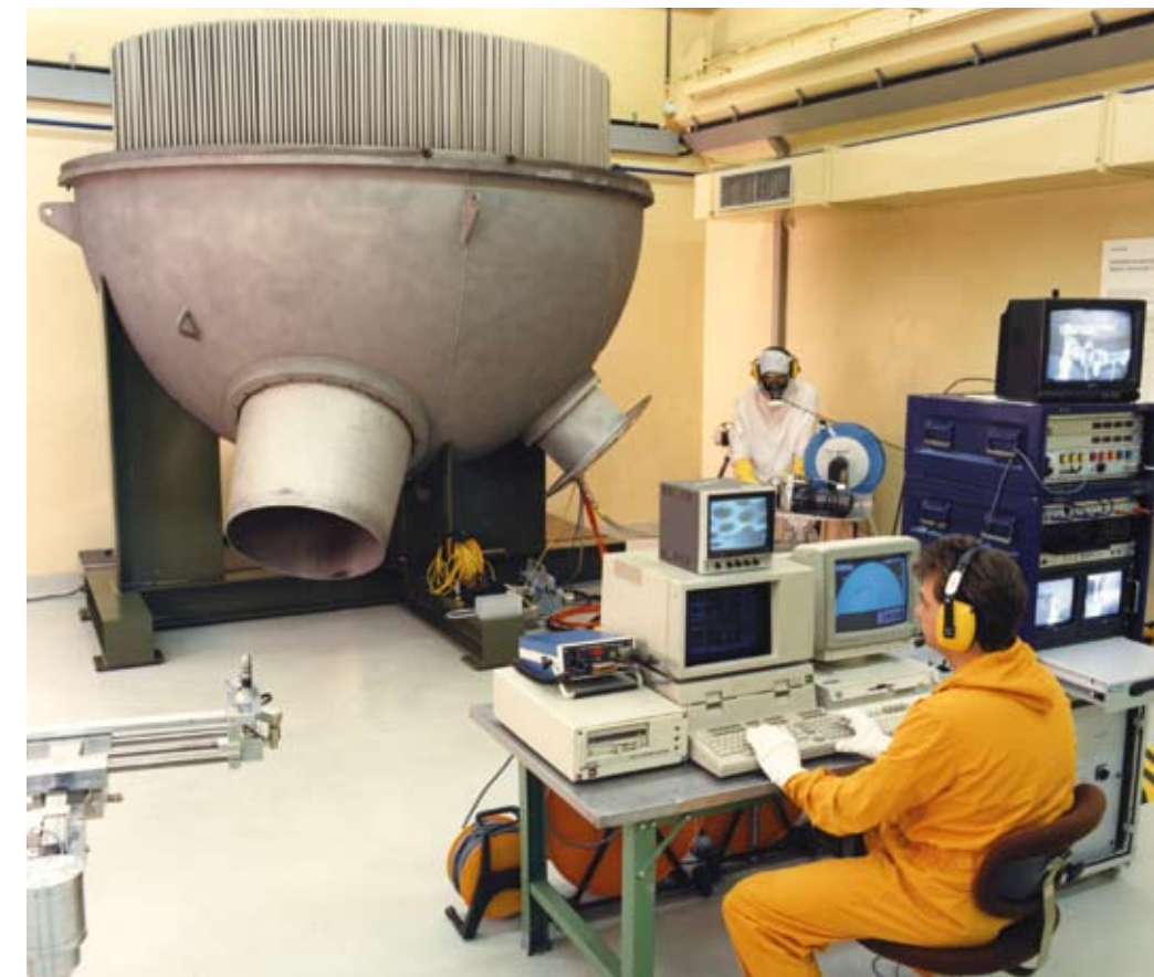
Training an der Attrappe eines Dampferzeugers für einen Serviceeinsatz (1991)
