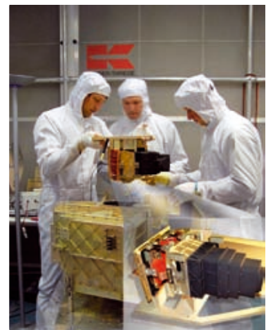
PACS: Kryogenes FIR-Instrument mit 59 optischen Komponenten, Detektoren und Mechanismen für Herschel-Planck-Mission
