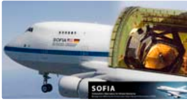
SOFIA: Infrarotteleskop der 2,7-m-Klasse für den Mitflug auf einer Boeing 747 (Bild: NASA-DFRC, C. Thomas, T. Tschida)
