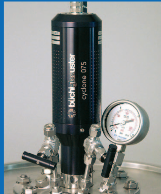
cyclone 075 on Büchi ecoclave cyclone 075 auf Büchi ecoclave
