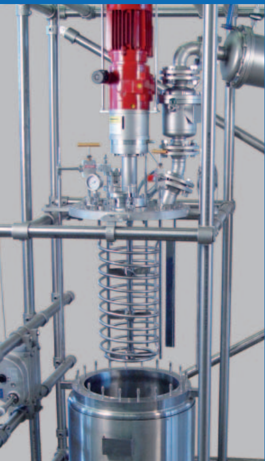
bmd 1800 on 80 liter hydrogenation reactor bmd 1800 auf 80 Liter Hydrierreaktor
