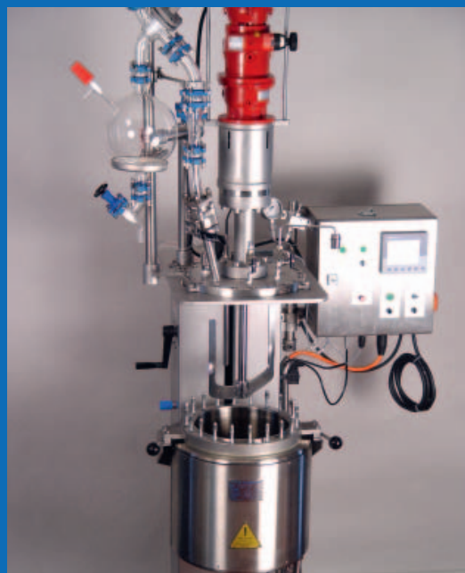
bmd 5400 on 20 liter polymerization reactor bmd 5400 auf 20 Liter Polymerisationsreaktor
