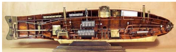
El Ictíneo de Narciso Monturiol (sección)
