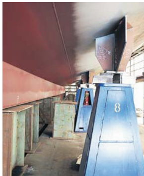
Noch ruht der Rumpf der „Alexander von Humboldt II“ in der Werfthalle auf den Palen. Ende Mai erfolgt die Wasserung.
