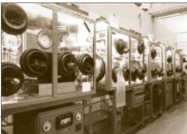
Handschoenkasten in de plutoniumlaboratoria. Een handschoenkast is een gasdichte, meestal uit doorzichtige kunststof vervaardigde kast waarin operatoren met behulp van in de kast reikende handschoenen bepaalde radioactieve stoffen, bijvoorbeeld plutonium, kunnen bewerken.
