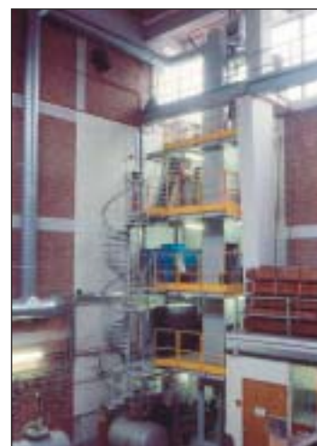
Om tritium te verwijderen uit vloeibare effluenten van een opwerkingsfabriek heeft het SCK•CEN het ELEX-proces ontwikkeld.
