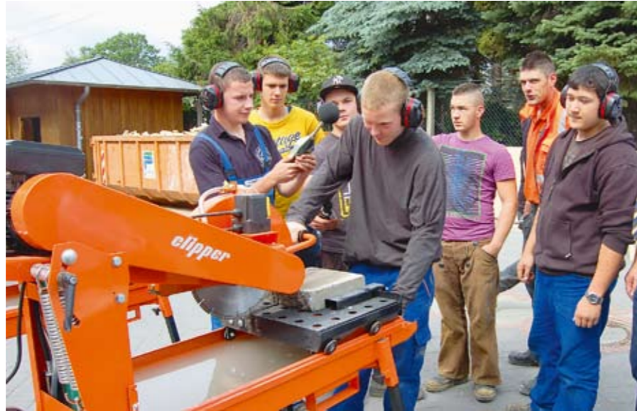
Gehörschutz ist Pflicht, auch wenn neue Maschinen wie dieser Steinschneider den Schallpegel am Arbeitsplatz senken. Messungen zeigen den Auszubildenden vom Bau: Der Lärm erreicht weiter schädliche Werte.
