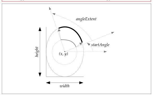
Figure 26: vguArc Parameters
