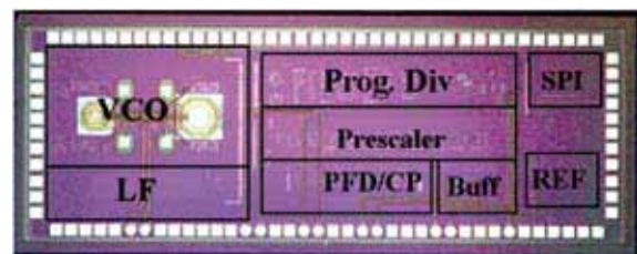
Abb. 15: Chip-Photo. Fig. 15: Die photo.
