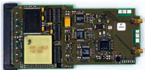
Abb.5: Am IHP entwickeltes IEEE 802.11a/g WLAN-Modul mit Unterstützung der Dienstgüte.
