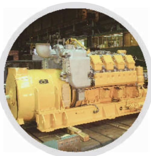
Модернизированные дизели 6ДМ-21Л в 8ДМ-21Л с улучшенными технико-экономическими и экологическими показателями адаптированы для использования в качестве силовых установок на маневровых тепловозах ТГМ-4Б и ТГМ-6Д.
