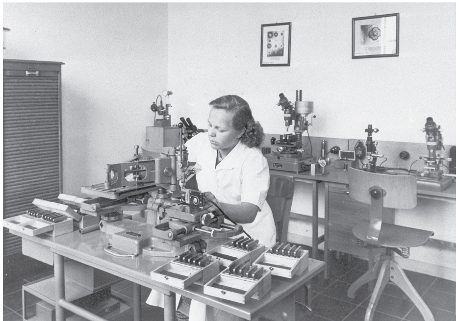
Bild: Kalibrierung von Härteprüfplatten
