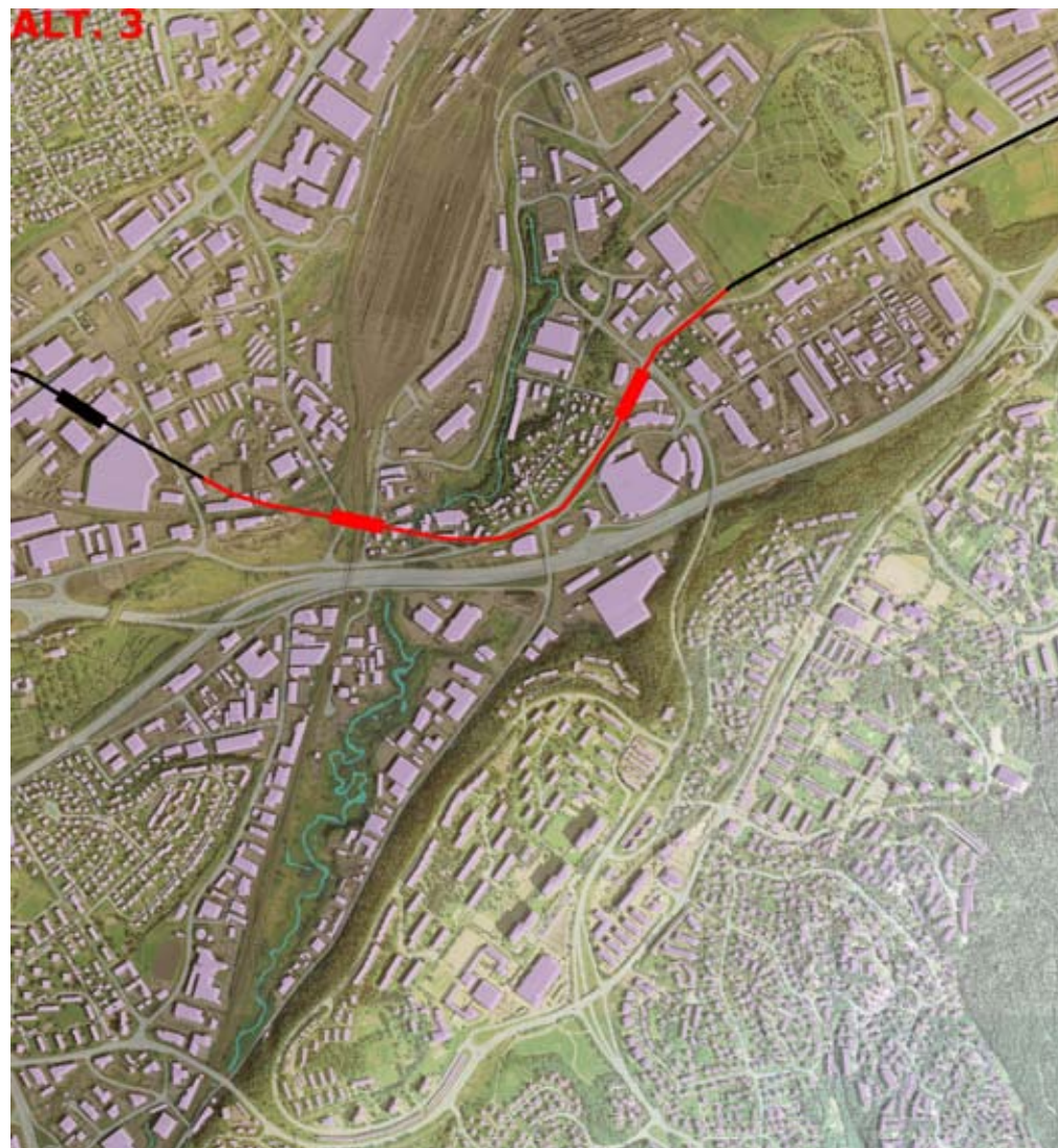
Ill. 47: Skisse av T-bane gjennom dalbunnen med stoppested på tvers, nord for E6. Rødt markerer hvor banen tenkes ført over bakken.
