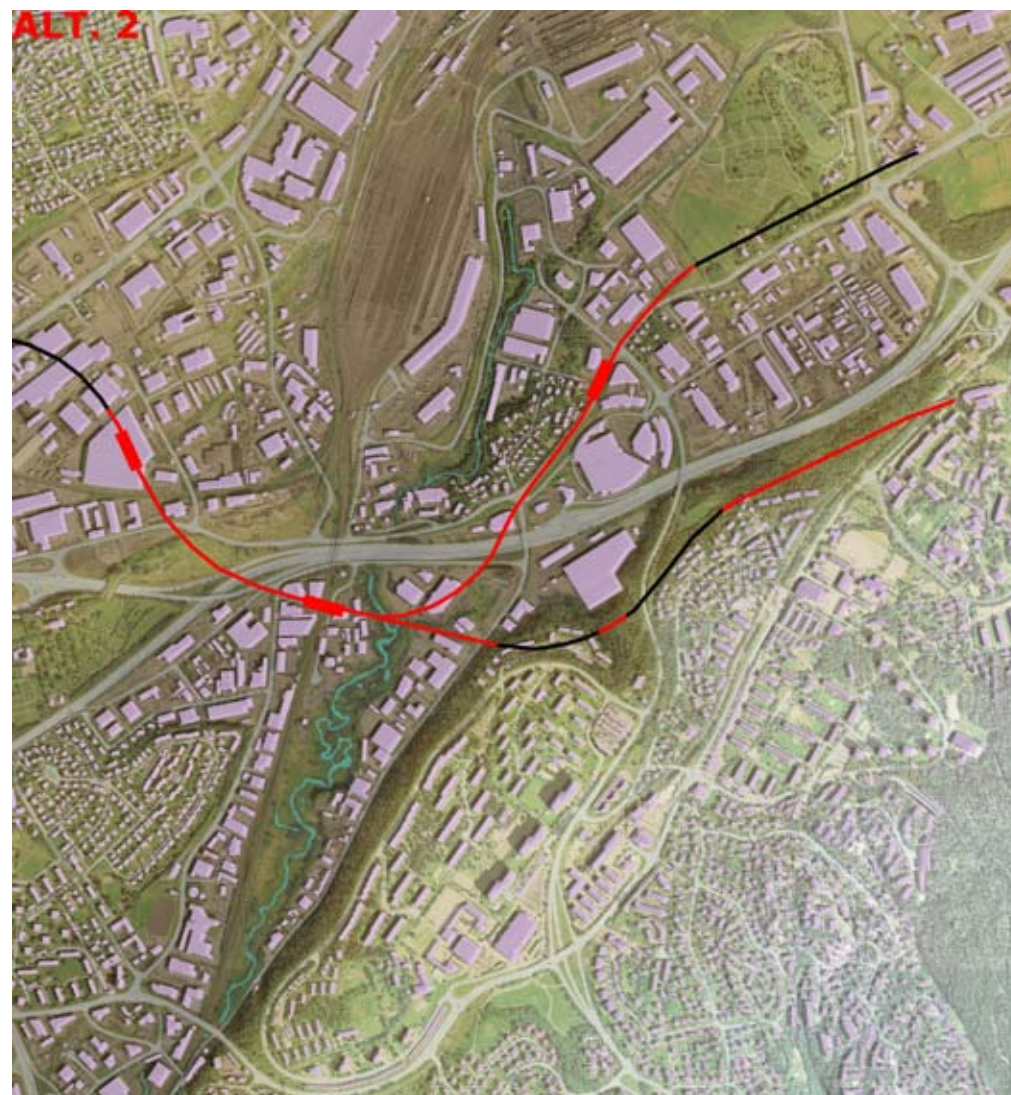
Ill. 50: Skisse av tverrforbindelse med stoppested på tvers, sør for E6 og avgrening gjennom dalbunnen. Rødt markerer hvor banen tenkes ført over bakken.
