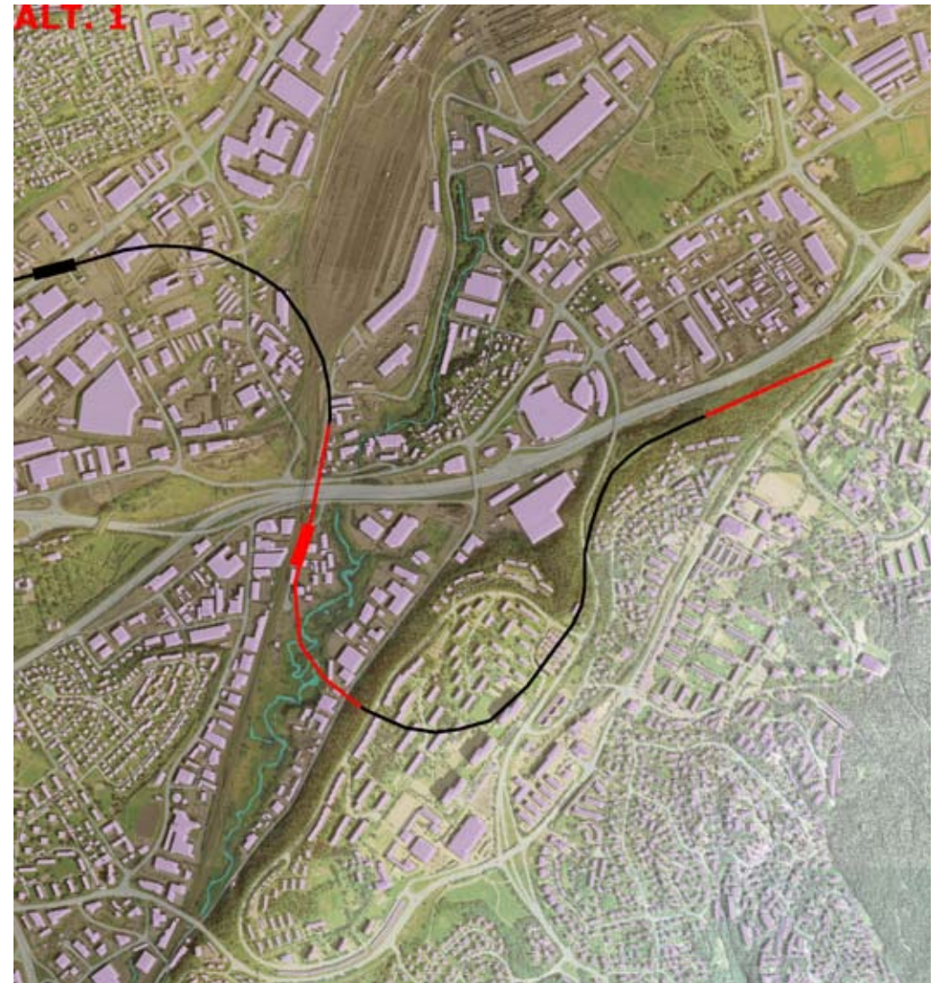
Ill. 44: Skisse av tverrforbindelse med parallelt stoppested sør for E6. Rødt markerer hvor banen tenkes ført over bakken.
