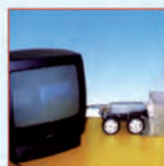
Pulizia e sanificazione degli impianti di condizionamento con robot dotati di teleispezione prima e dopo l'intervento (D.L. 626/sett.94)
