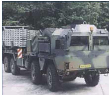
MAN KAT 1 KMW / IBD (Mexas system)
