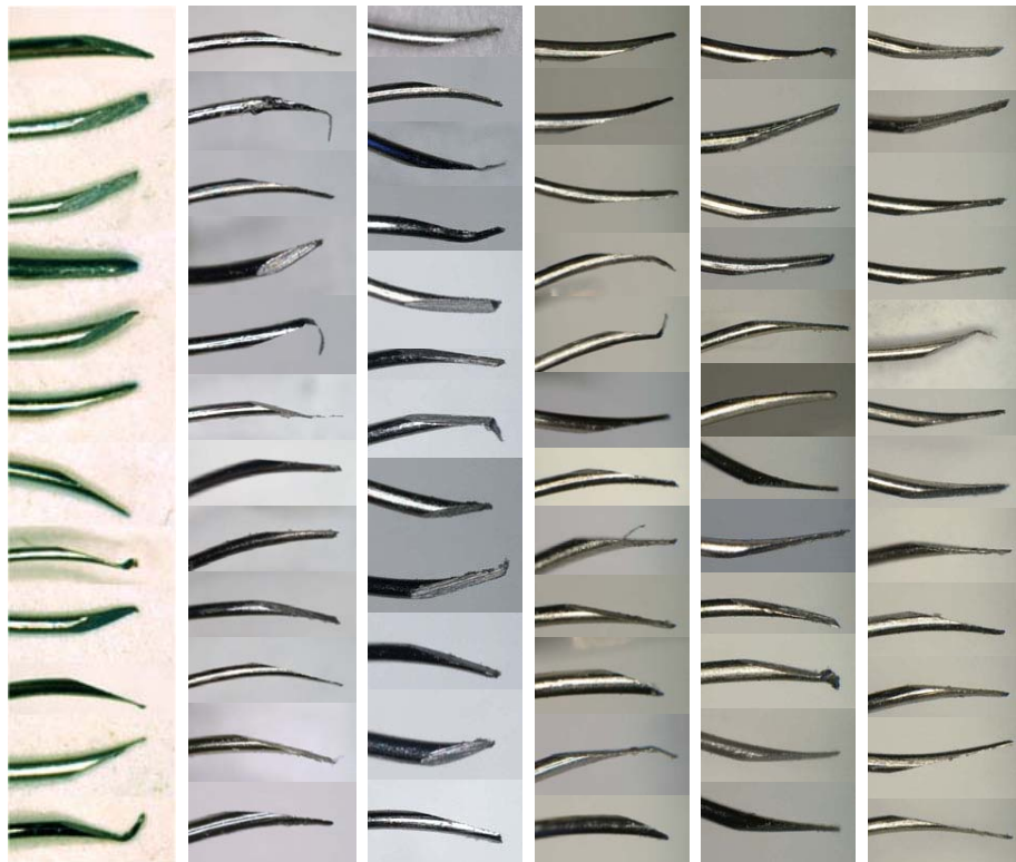
Profils d'usure des fils appartenant aux couronnes extérieures des torons externes
