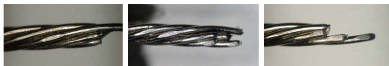
Plages d'usure observées sur les fils intérieurs de torons externes
