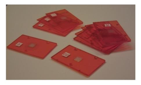
FIGURE 7.1 TOKENS USED IN THE PHYSICAL AUTHENTICATION SYSTEM. NOTE THE EPOXY SYSTEM IN THE CENTER AND THE REGISTRATION HOLES ARRANGED IN A TRIANGLE.
