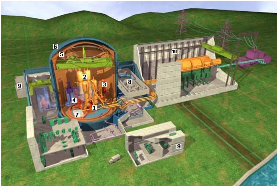
Figuur C.1 Doorsnede van de EPR met daarin het primaire systeem bestaande uit het reactorvat (1), de stoomgeneratoren (2), de drukhouder (3) en de hoofdkoelmiddelpompen (4). Verder zijn aangegeven het dubbele containment (5, 6), de kernsmeltopvang (7), de regelzaal (8), de noodstroomdieselgebouwen (9) en het turbinegebouw (10).
