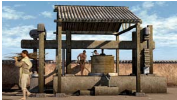
Recreación infográfica de la prensa de un ingenio azucarero en la que se extrae el jugo a la caña antes de proceder a cocerlo para obtener la melaza.
