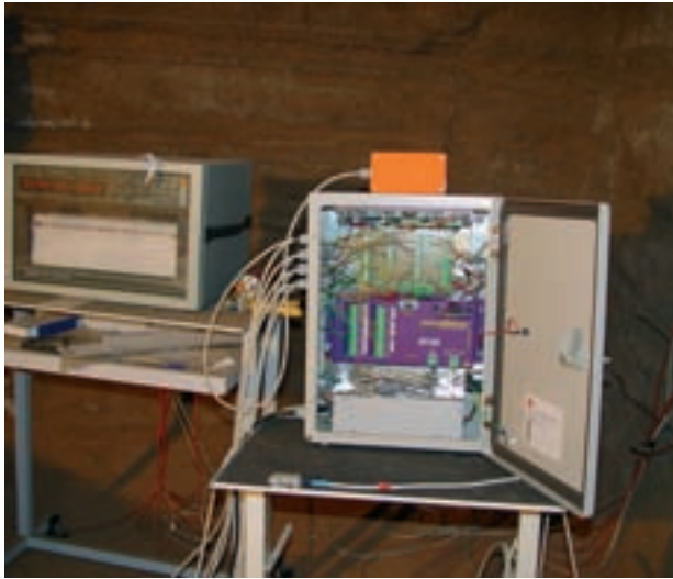
■ Foto 21. Equipos de registro de los parámetros microclimáticos instalados en el interior de la Cueva Pintada en 1991 y 2003.
