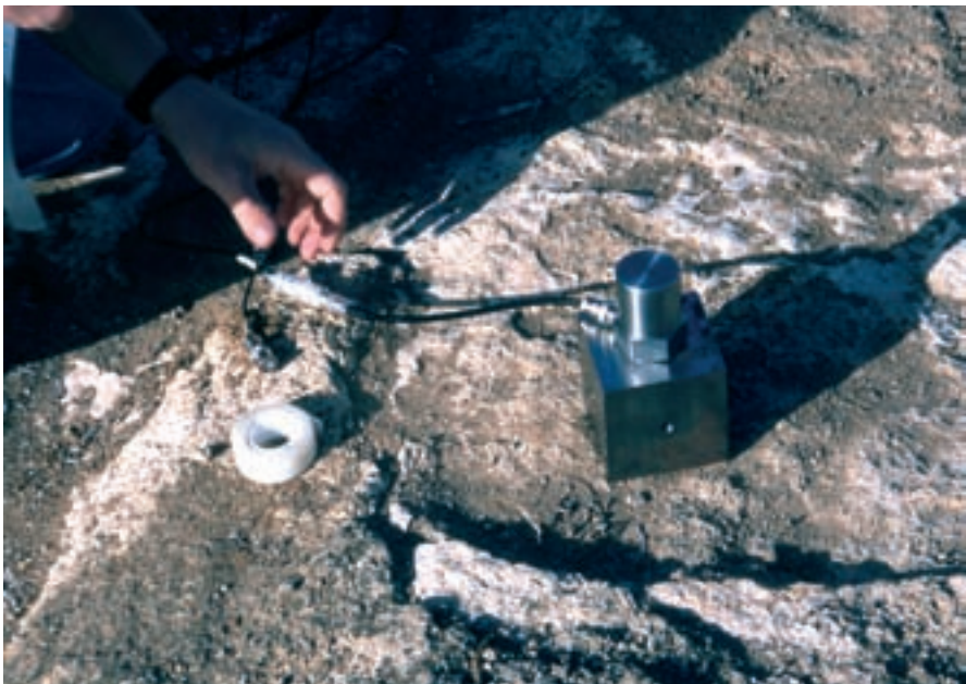
■ Foto 10. Instalación de sismógrafo en el exterior de la cueva.
