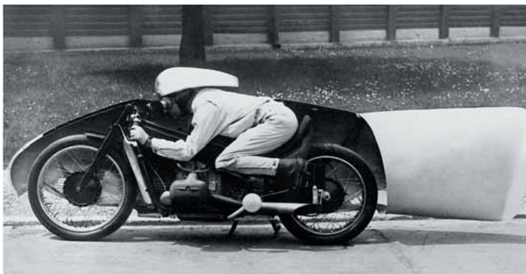
Das Schnittmodell zeigt die beengte Sitzposition in der Rekordmaschine. This cutaway model shows the cramped riding position on the record-breaking bike.
