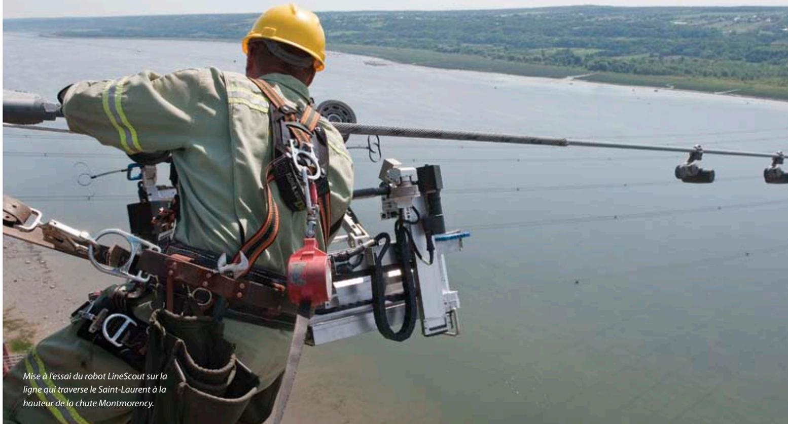
Mise à l'essai du robot LineScout sur la ligne qui traverse le Saint-Laurent à la hauteur de la chute Montmorency.
