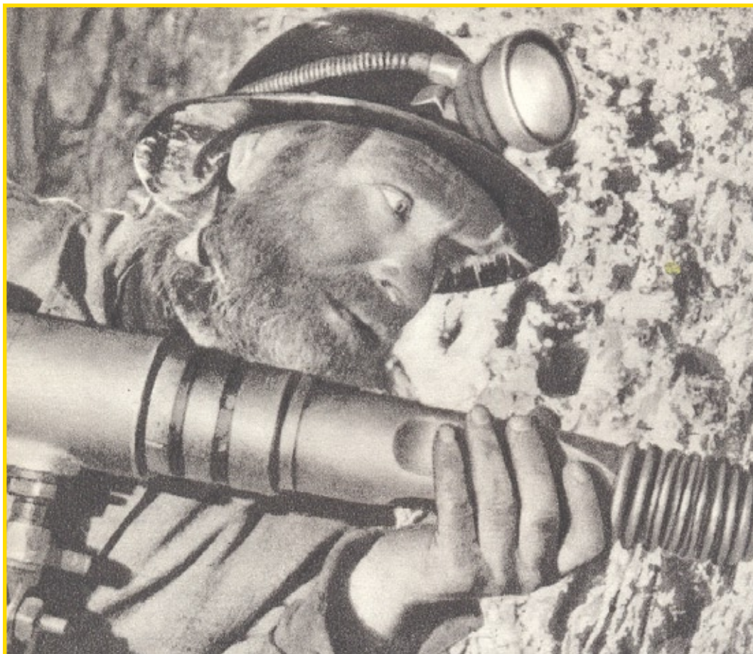
Górnik przy pracy. Wiercenie otworu strzałowego
