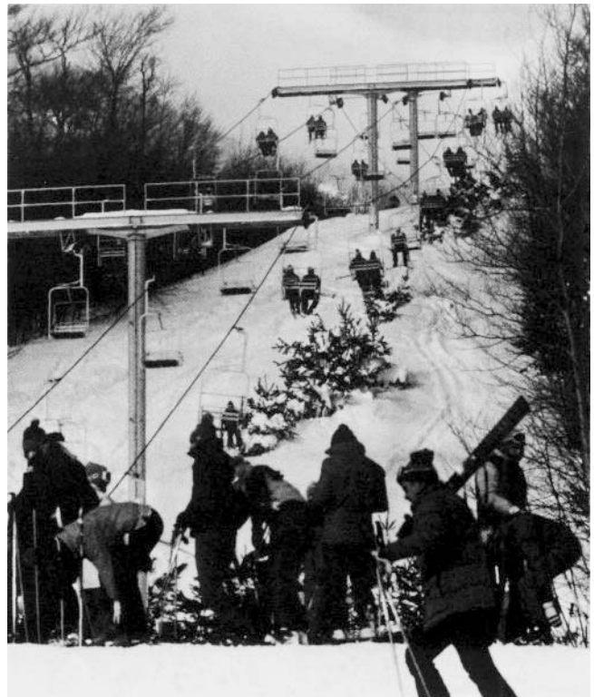
Double-double lift accommodates 2,000 skiers per hour Ce double-double remonte-pente permet de prendre en charge 2000 skieurs à l'heure
