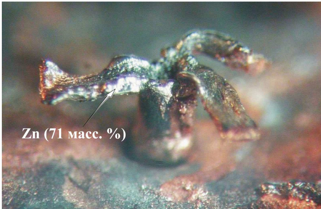
Рис. 9. Медная мишень после эксперимента со следами застывшей серебристо-белой «лавы» на ее лепестках, вылившейся из центра взорвавшейся мишени.
