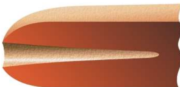
Рис. 5. Модель продольного сечения мишени после эксперимента с тонким осевым каналом.
