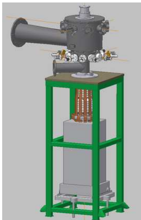
Рис. 4. Экспериментальная установка предназначенная для сверхфокусировки энергии электронного микропучка.
