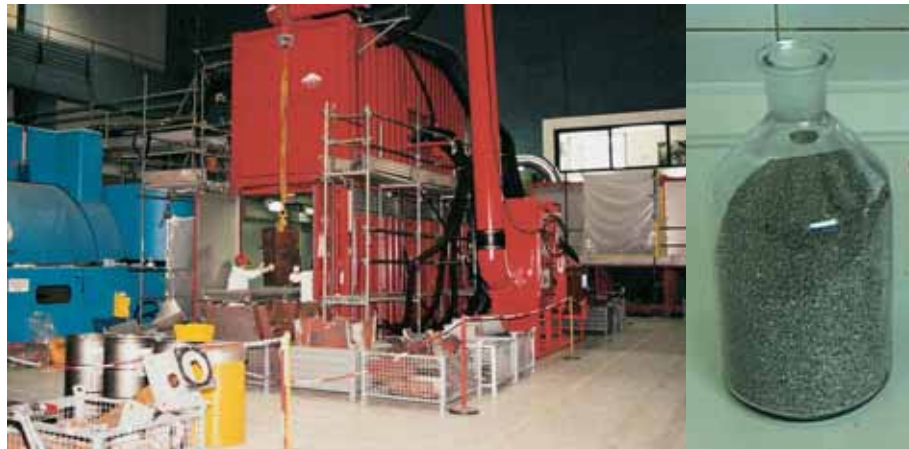
Stahlkiesstrahlanlage in Containerbauweise
