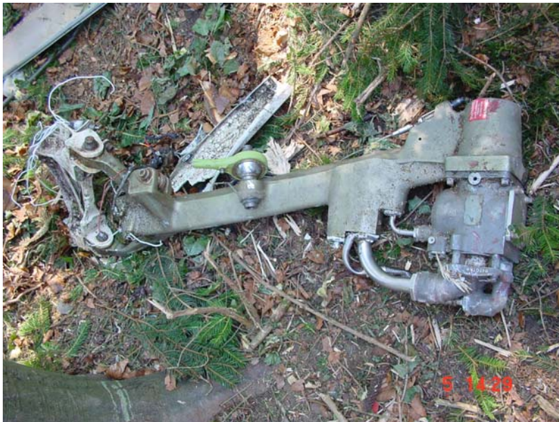
Ram Air Turbine ohne Propeller
