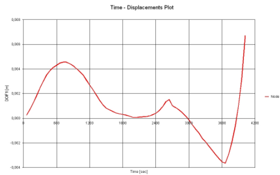
Abb. 4-18: Verformung u_x in Stützenmitte in Abhängigkeit von der Zeit – Variante 3
