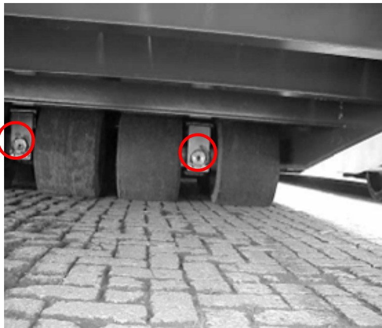
Figur 42 Boogieändens tippunkter på en normal 40-fots rolltrailer.
