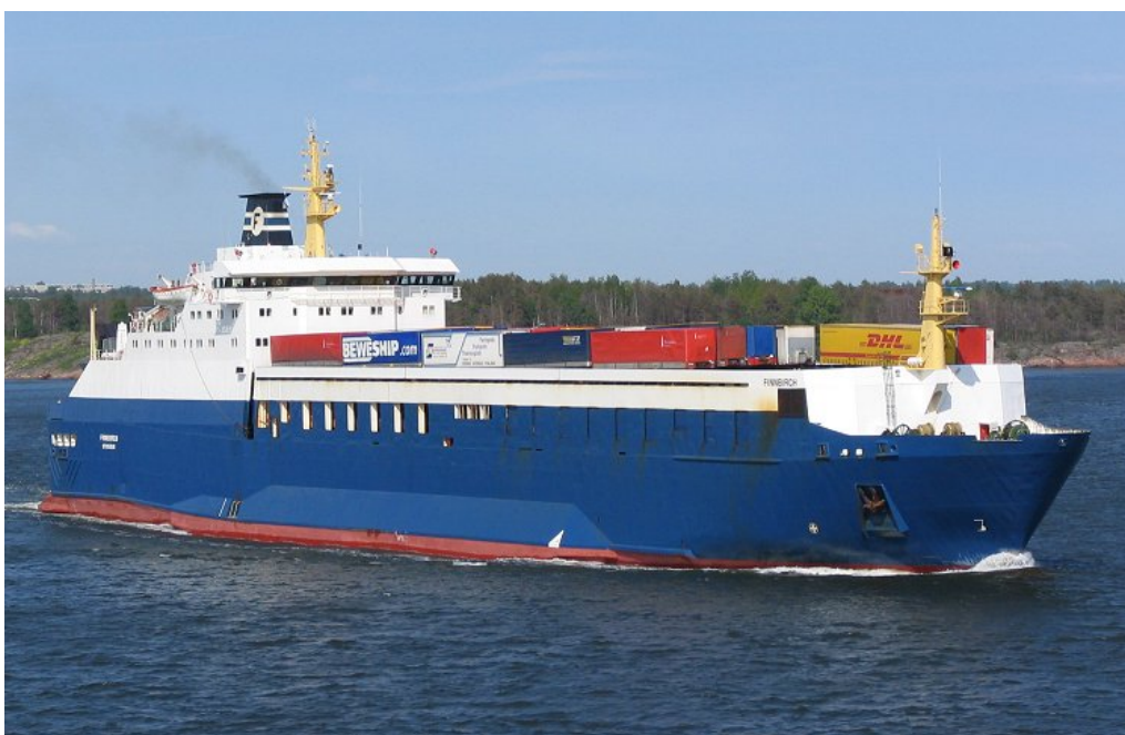
Figur 1. Finnbirch under en sjöresa med last av semitrailrar på Weather Deck. På Upper Deck ses öppningar i fartygssidan. De förliga öppningarna är försatta med träskivor (walkingboard). Längst akterut ses öppningarna vid poop-däcket. Midskepps, vid vattenlinjen, ses påsvetsade sponsorer.
