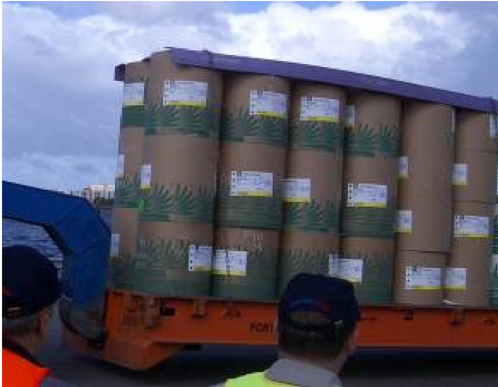
Figur 8 Pappersrullar på rolltrailer under lossning av M/V Antares i Rostock i september 2004. Två kättingar per kantskydd säkrar denna last.
