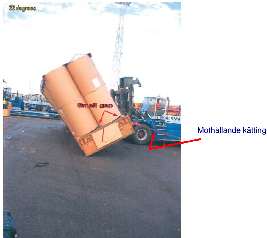
Figur 43 Lutningsprov som visar att högt lastade rolltrailrar är mycket tippningsbenägna.
