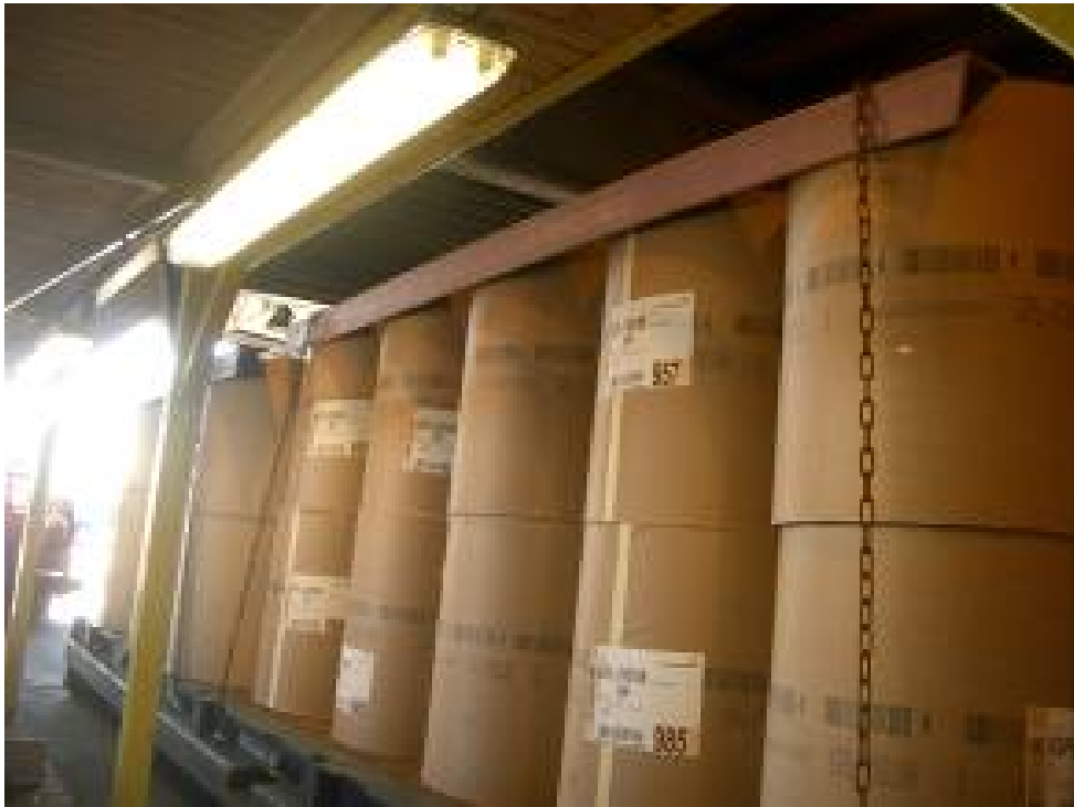
Figur 9 Pappersrullar lastade på en lastbärare i terminalen i Helsingfors – en lastsektion som är 5,25 m lång, och säkrad med långa kantskydd och två kättingar. Fotot taget vid SHK:s besök i september 2007.
