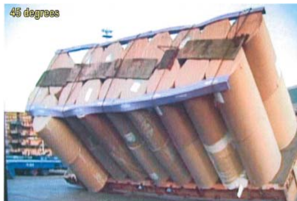
Figur 44 Lutningsprov, Finnlines, oktober 2007.
