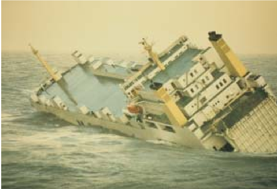
Figur 53 Vinca Gorthon med kraftig slagsida efter förskjutning av skogsprodukter lastade på rolltrailrar.
