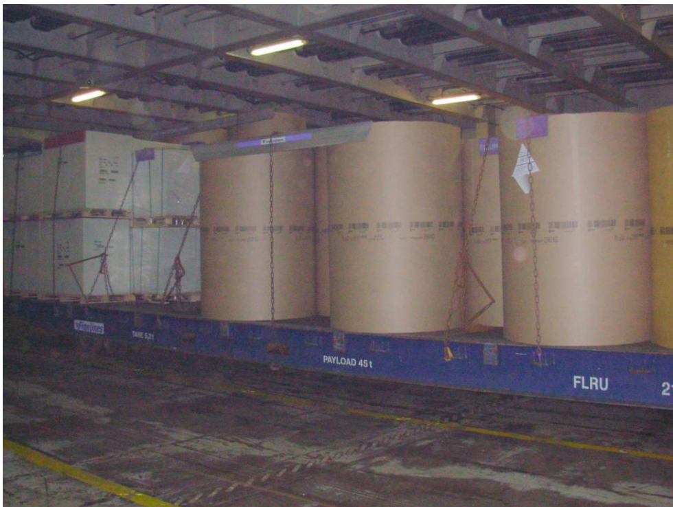
Figur 10 Lastsäkring av rullar med stor diameter ombord i systerfartyget Finnforest. En surring har lagts mitt över ett långt kantskydd som håller två rullar. Till vänster om denna last syns pallat gods i form av arkat papper. Fotot taget vid SHK:s besök i september 2007.
