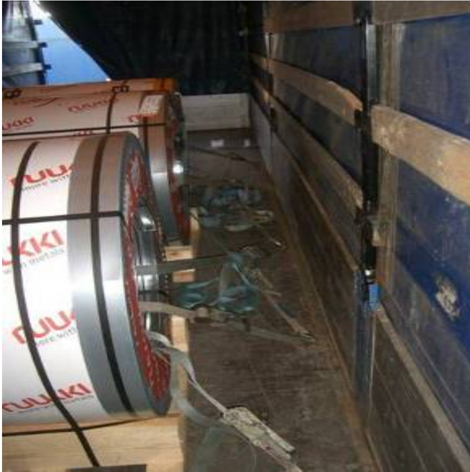
Figur 14 6-tons stålplåtrullar från Rautaruukki lastade i semitrailer ombord i Finnforest. Dessa är surrade enligt företagets instruktioner.
