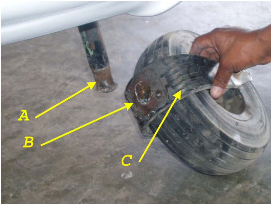
Fotografía del conjunto del tren de nariz que nos muestra la separación del tubo (A) de la plancha de acero (B). La letra (C) nos muestra el tenedor de fibra de carbono aun con la rueda puesta.
