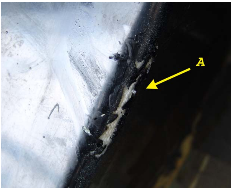
Detalle del daño del tanque de combustible ocasionado por el mecanismo de guía del tren de nariz.
