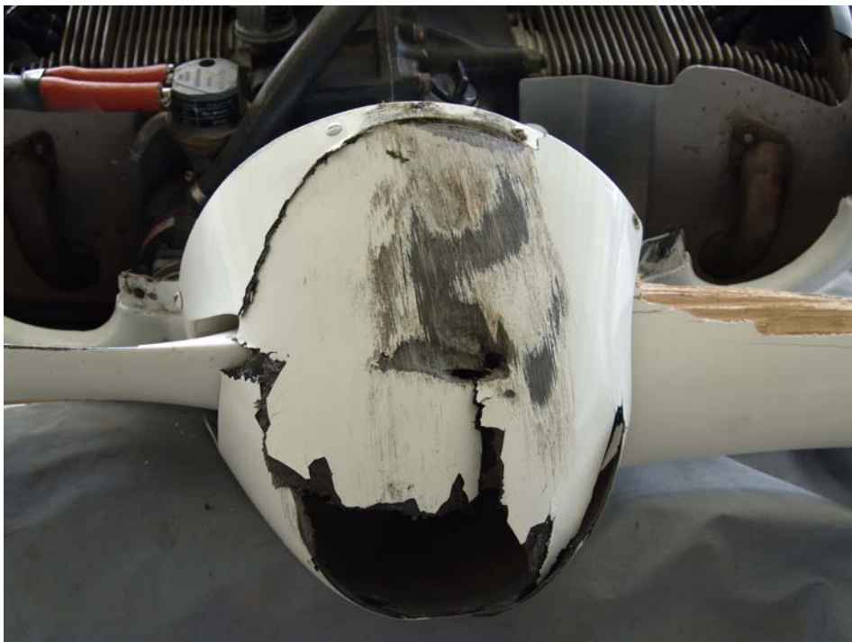
Detalle del daño al spinner de la hélice.
