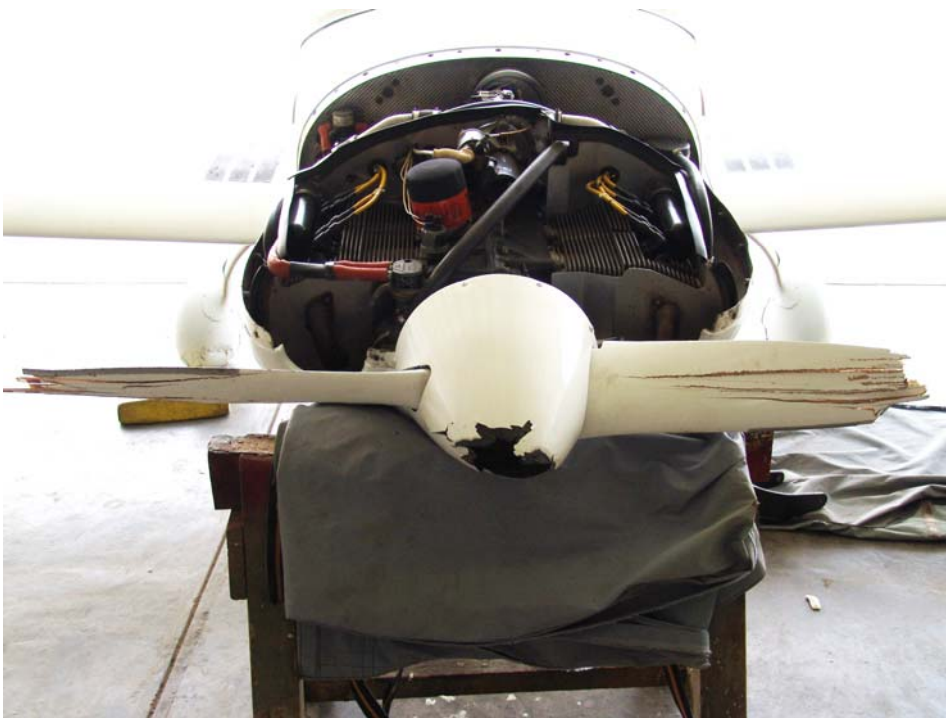
Daños a las palas y spinner de la hélice.
