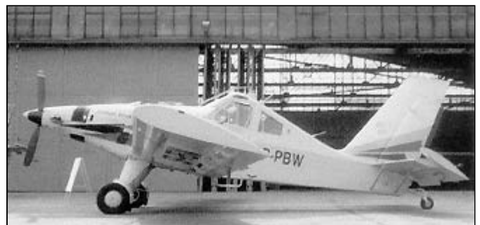
PZL-106BTU SP-PBW silnik turb. PT-6 (1998)
