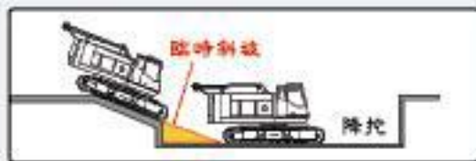
八里新店快速道路高架橋下全套管基樁模擬圖
