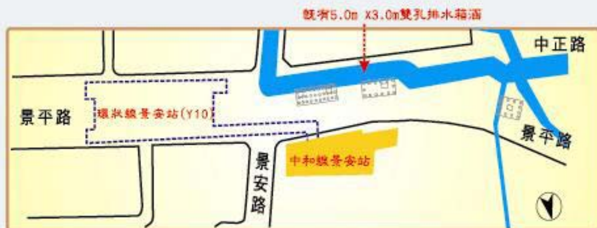
景平路捷運景安站前雙孔排水箱涵示意圖(完成後仍維持雙孔排水)
