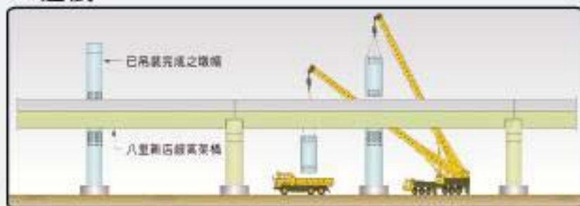
高架橋墩及帽梁施工模擬圖
