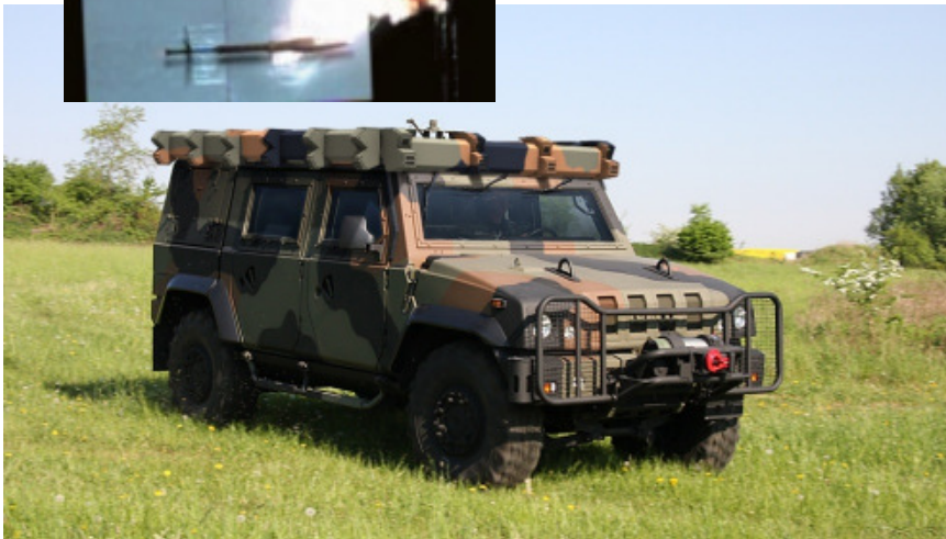
LMV de IVECO con el ADS de IBD adicional. La pequeña foto enseña el momento de encuentro de la descarga energética del ADS sobre el proyectil muy poco antes del impacto.
