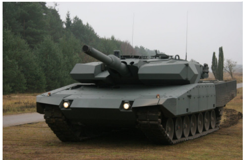
Carro de Combate Leopard 2 A4 con el blindaje pasivo adicional "Evolución" de IBD que cubre también el techo del vehículo. (Foto: vía autor)
