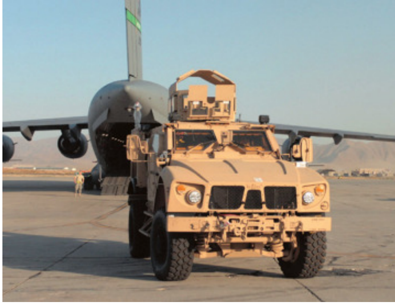
Vehículo M-ATV (MRAP All Terrain Vehicle) de Oshkosh, saliendo de un avión de transporte C-17 en Afganistán. Es el primer vehículo de una serie de varios miles que dicha empresa está fabricando para las Fuerzas Armadas de EE.UU., especialmente para terrenos tan difíciles como los de Afganistán. El blindaje es de Plasan. El vehículo es algo más pequeño que el tipo MRAP conocido y tiene más potencia y movilidad. (Foto: US Air Force)
