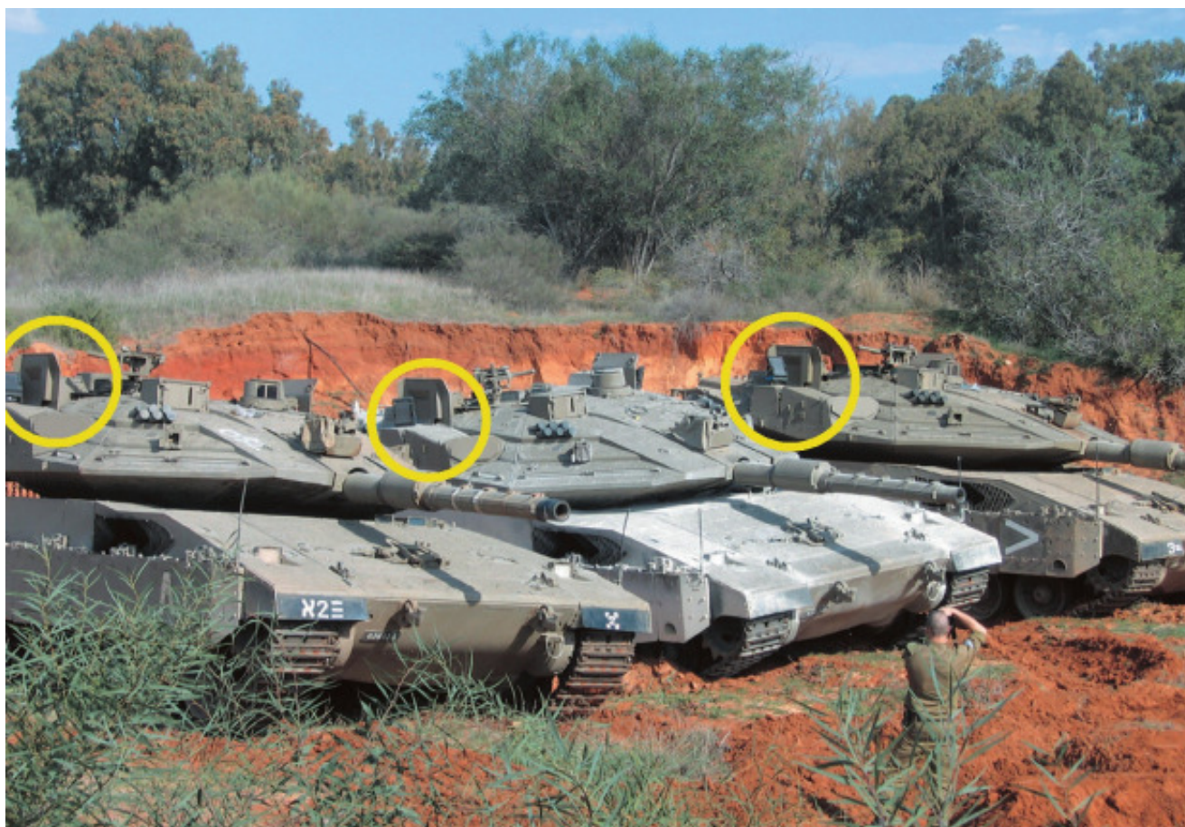
El sistema TROPHY de Rafael montado sobre carros de combate Merkava IV. En amarillo, los elementos Trophy en el lado derecho del vehículo, que tienen su correspondencia en el lado opuesto. (Foto: Rafael)
