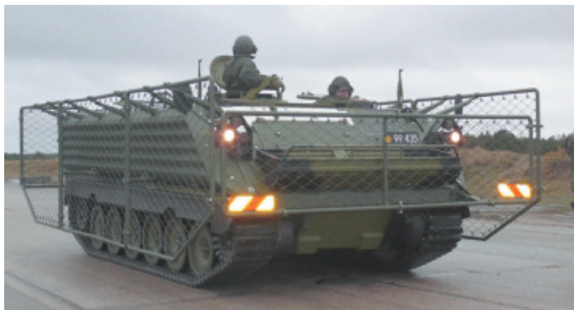
Blindaje pasivo adicional SLAT de RUAG GEKE, denominado LASSO. Este tipo de protección pasiva lo aprovechan bastantes vehículos de combate en Iraq y Afganistán. (Foto: RUAG)
