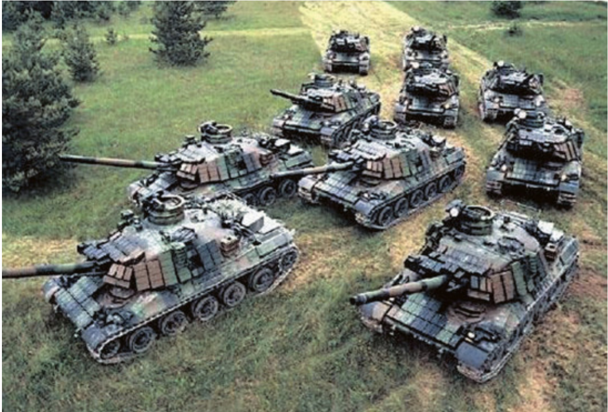
Carros de combate AMX-30B2 franceses con el blindaje reactivo BRENUS de Nexter. Pocos países occidentales hacen uso de sistemas reactivos. (Foto: Archivo Mönch Internet)
