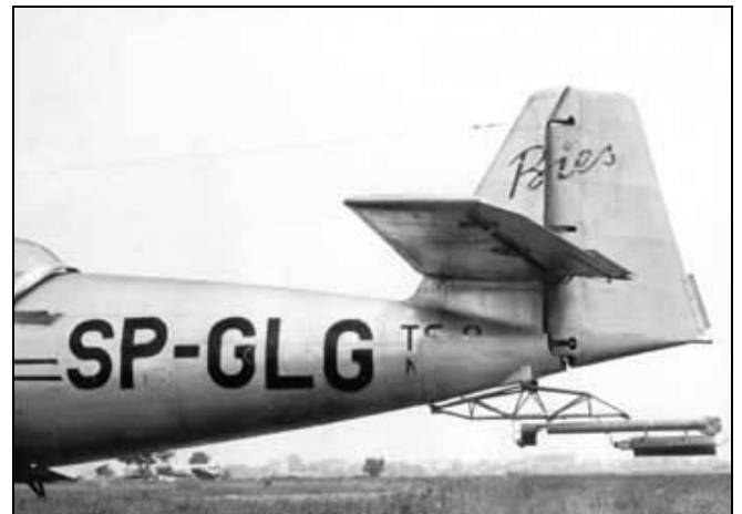
Próby spadochronu przeciwkorkociągowego na SP-GLG
