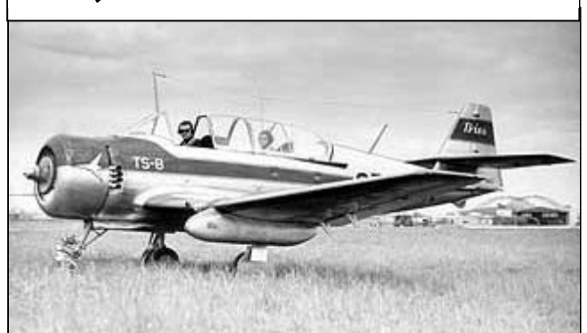
Wersja „paryska” P2 ze śmigłem Hamilton, dodatkowym zbiornikiem 80l i anteną mieczową
