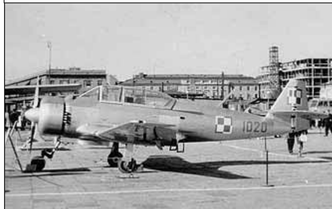
TS-8 BII z WSK-Mielec z deflektorem kierującym ciepłe powietrze na przednią szybę
