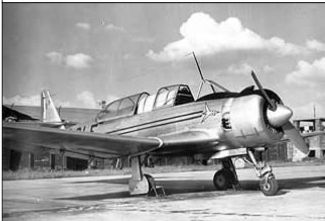
Wersja rekordowa P1 ze zbiornikiem w 2 kabinie i chwytnymi powietrza pod i nad slinikiem
