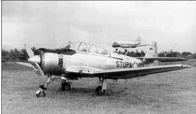
TS-8 BII – w wersji dla Indonezji z wykrojami w osłonie silnika i dodatkową spiralną chłodnicą
