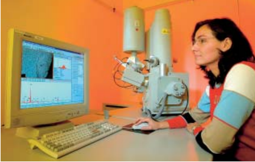
Rasterelektronenmikroskop FEI Sirion XL30 mit Feldemissionskathode, Auflösung \geq 2 nm.
