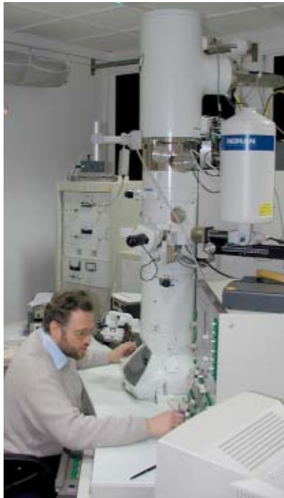
Transmissionselektronenmikroskop Jeol 2010 F (200 kV) mit Feldemissionskathode, Auflösung \geq 0,2 nm. (Alle Geräte im Betrieb bei der AQura GmbH.)
