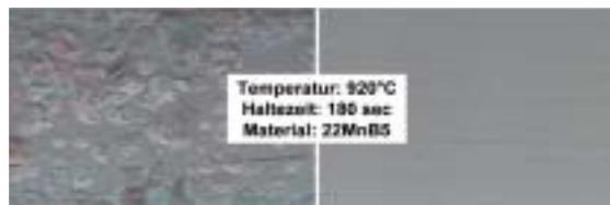
Bei der Warmumformung bildet sich auf der glühenden Stahloberfläche durch Oxidation ein rauer und spröder Zunderbelag (links). Dies kann wirkungsvoll durch eine neuartige Nanokompositbeschichtung verhindert werden (rechts).
