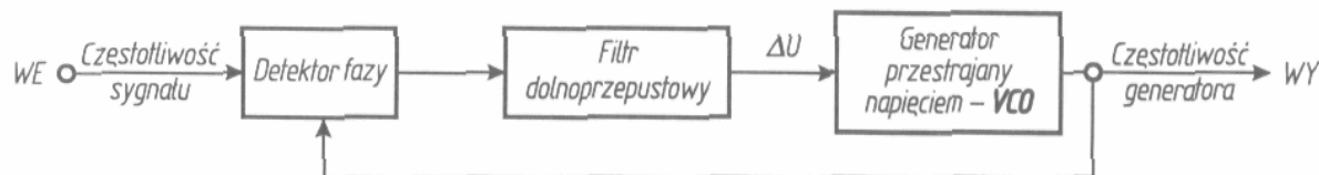
Rys. 23. Schemat blokowy pętli fazowej PLL
