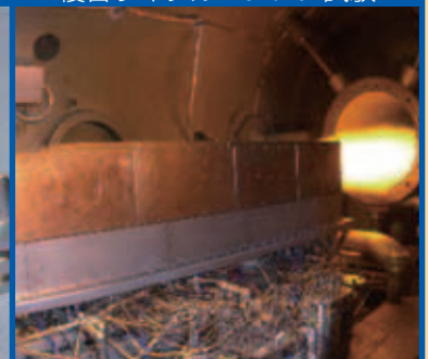
複合エンジン燃焼器試験
