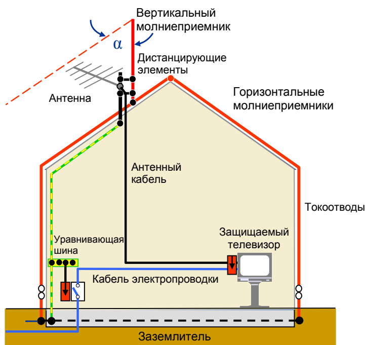
Рис. 22. Защита мачты и антенны от прямого удара молнии [1]
