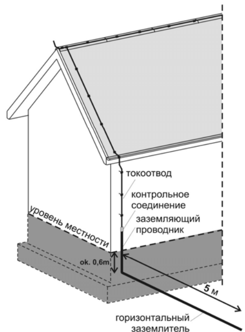
Рис. 42. Контурный заземлитель в строительном объекте a)общий вид, b) соединение заземлителя с заземляющим проводником
