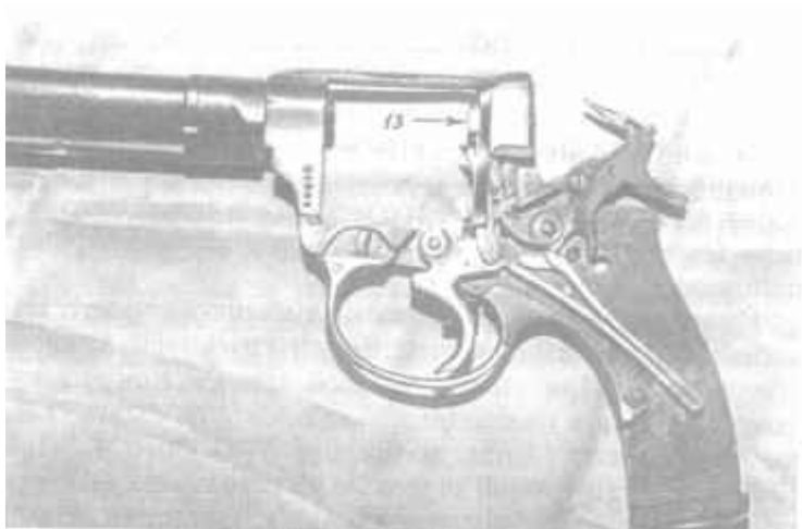
Фото 5. Положение деталей при предварительно взведенном курке — казенник 13 выдвинут вперед
