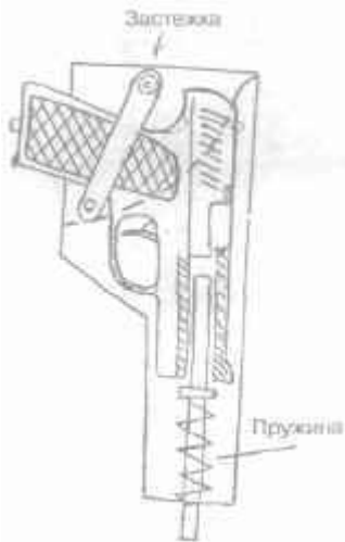
Схема 52. Принцип действия «итальянской» кобуры
