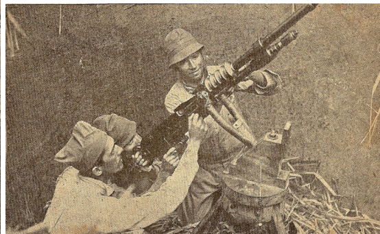
Metralhadoras convertidas para serem antiaéras SCHWARTZLOSE (austríaca) e HOTCHKISS (francesa) de 7mm prontas para ação. (Fotos: Miguel Falletti)
