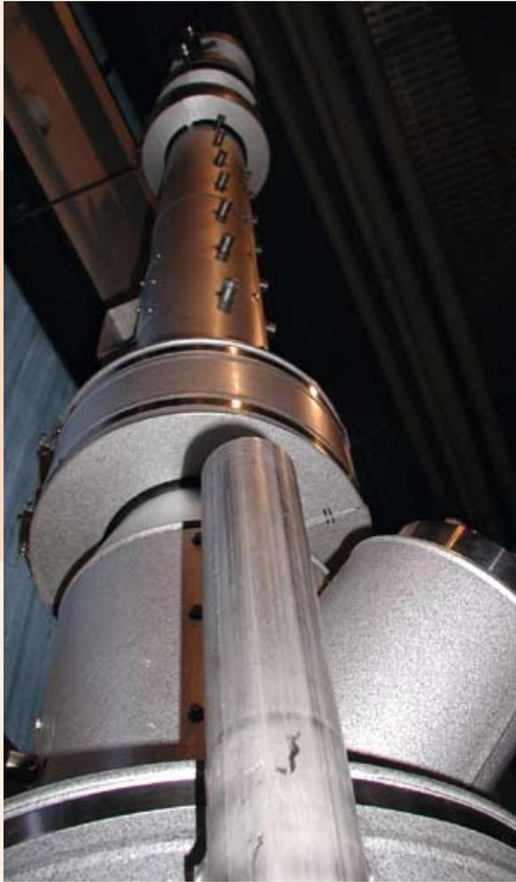
Versuchsanlage zum Oxyfuel-Prozess mit Rektifikation der Rauchgase zur Erzielung höchster Reinheiten an der TU Dresden.
