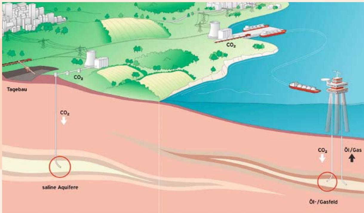
Schematische Darstellung der unterirdischen CO<sub>2</sub>-Speicherung. Speichermöglichkeiten bieten etwa ausgebeutete Öl- und Gasfelder oder saline Aquifere.
