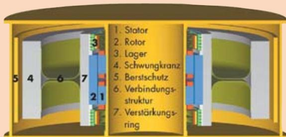
Modell „Dynastore“: Schwungmassenspeicher der neuen Generation sind in wenigen Jahren anwendungsreif, um Elektrizität kinetisch zu speichern.
