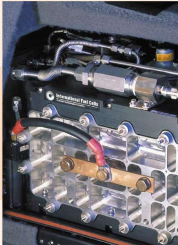
Eine Benzin- und Diesel-Brennstoffzelle (SOFC) zur Stromerzeugung für das Bordnetz eines Pkw.
