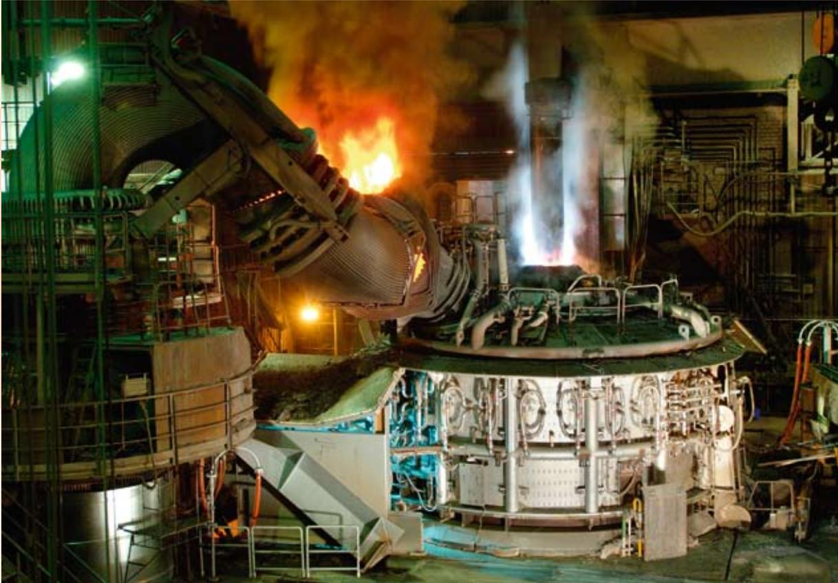
Ein Ofen zur Herstellung von Elektrostaahl verbraucht leicht so viel Strom wie eine Kleinstadt. Mit Öfen, die nach dem Schaumslagke-Verfahren arbeiten, kann man den spezifischen Stromverbrauch um etwa 5 Prozent senken.
