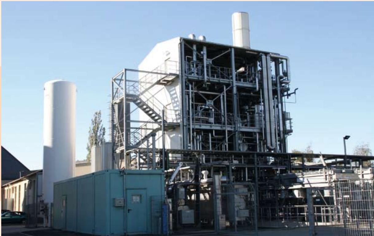
Versuchsanlage zur Hochdruck-Partialoxidation an der TU Bergakademie Freiberg
