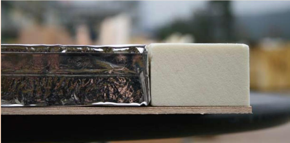
Hochgedämmte Vakuumisolationspaneele (VIP) sind wegen der extrem geringen Wärmeleitfähigkeit nur wenige Zentimeter dick. Zu sehen ist das Innere der VIP mit weißem Polyurethan-Randstreifen; eine Abdeckung aus Edelhölzern, OSB (Grobspanplatten), Glas, Aluminium oder Edelstahl bildet die optisch fertige Oberfläche.
