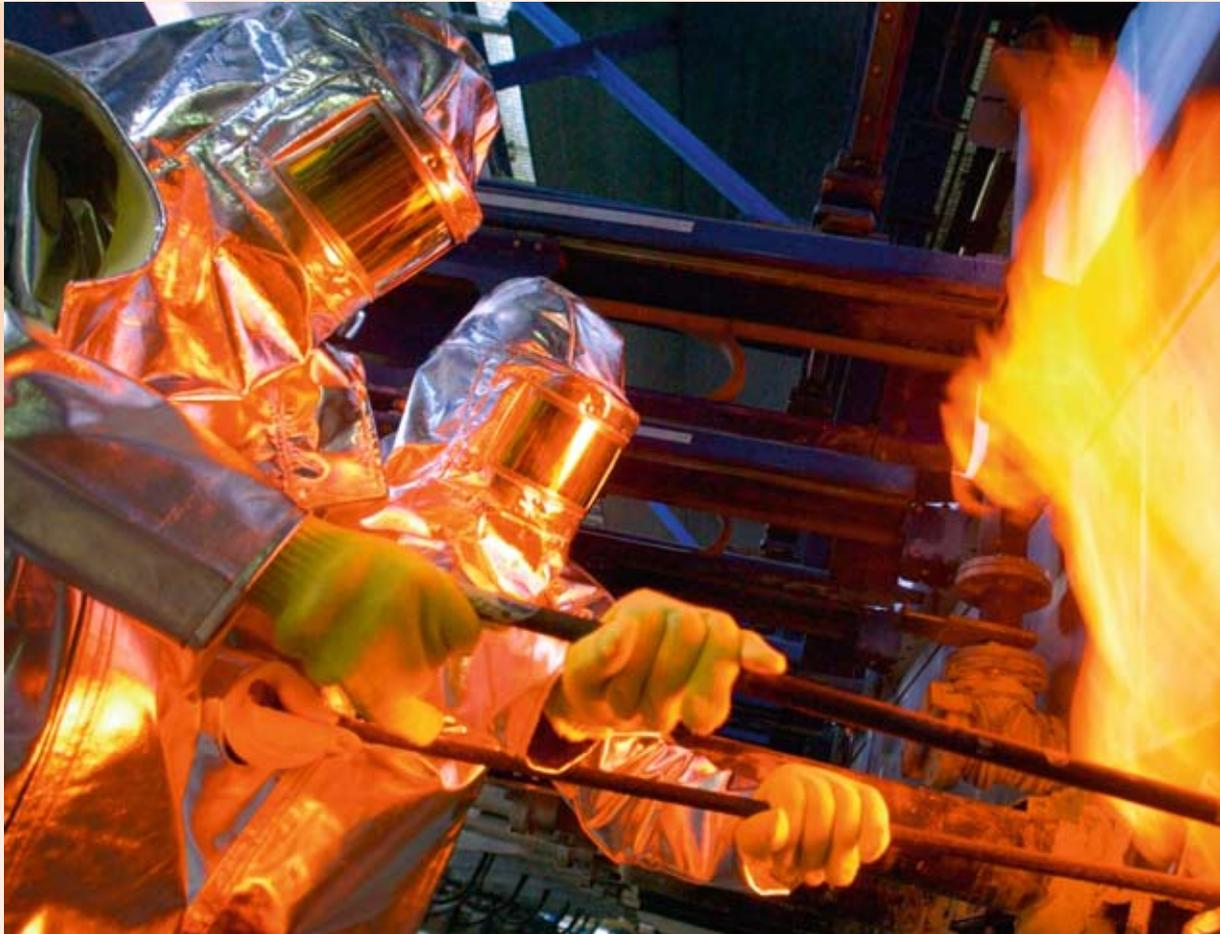
In der Glasindustrie beträgt die Schmelztemperatur je nach Glastype und Materialzusammensetzung zwischen 1000 und 1600 Grad Celsius. Neuartige Dämmstoffe können auch hier die Wärmeverluste der Öfen verringern.
