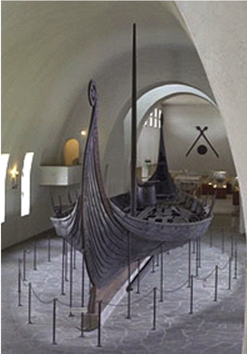
Das Oseberg-Schiff, Wikingerschiffsmuseum, Oslo Dieses Wikingerschiff wurde in einem Grabhügel in Vestfold gefunden und 1904 ausgegraben. Es ist aus Eichenholz, 22 m lang, 5 m breit.
