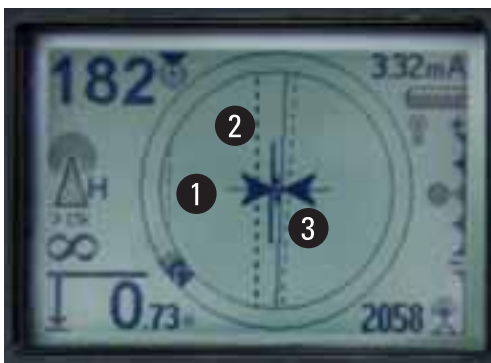
Pantalla en modo Omniseek: visualización de varias líneas (la imagen muestra tres líneas distintas) ①, ②, ③
