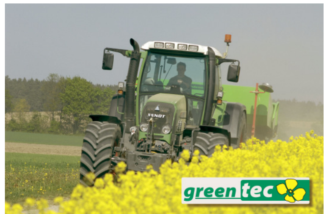
FENDT 820 Vario Greentec (TCD 2012 L06-4V 152 kW / 2100 min -1 )
