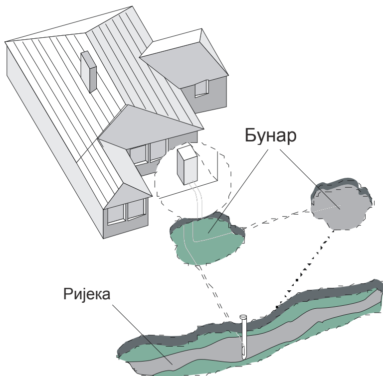
Слика 10.7: Отворени геотермални систем
